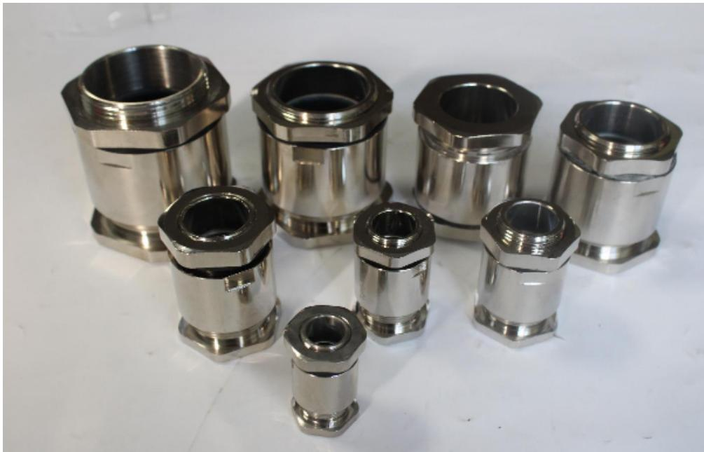
填料函抗拉力特强，可防水、防尘、抗盐、耐弱酸、酒精、油、油脂及一般溶剂。防护等级：在规定的卡口范围内，并使用密封圈旋紧迫紧头，达到IP68-10Bar。产品材质：不锈钢搭配硅胶制成。使用方法：先将钢管或者挠性管对接在防爆接头内螺纹处，电缆线通过钢管后，拧紧螺帽即可。防爆填料函产品说明：防爆填料函接头型采用良好304不锈钢（或黄铜，铜镀镍）原材料配合先进数控机床精加工制成，内置隔爆衬套和电缆卡环，防爆功能特强，适用于各类防爆挠性管，防爆钢管对接。
